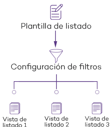
Figura 3.11: Generación de tres listados a partir de una misma plantilla / fuente de datos
